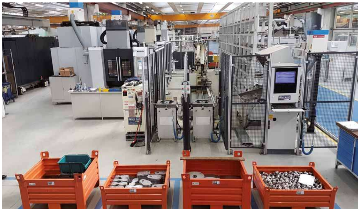
Stabilimento Gai Macchine Imbottigliatrici: FMS composto da un magazzino pallet da 165 posti e due centri di lavoro a 5 assi asserviti da un robot antropomorfo su settimo asse a pavimento dotato di pinze e cambi rapidi Schunk
