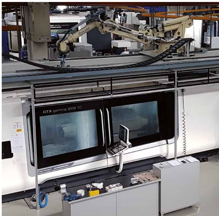
Dall'esperienza maturata da Quick Load nella realizzazione di robot cartesiani a portale, nasce la soluzione automatizzata con robot su settimo asse appeso impiegata in Gai
